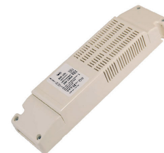
Ref : TL 24MDE 60 Alimentation 24Vdc ON/OFF DIM TRIAC Puissance max : 60W Dimensions : 205x51x35mm
