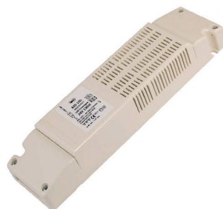
Ref : TL 24MDE 200 Alimentation 24Vdc ON/OFF DIM TRIAC Puissance max : 200W Dimensions : 205x51x35mm
