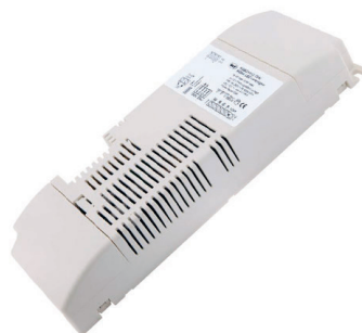
Ref : TL DALI 100 Alimentation 24Vdc ON/OFF DIM DALI Puissance max : 100W Dimensions : 210x75x35mm
